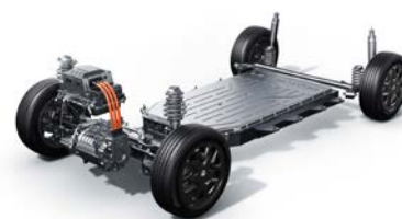
Umístění trakční baterie v podlaze vozu
